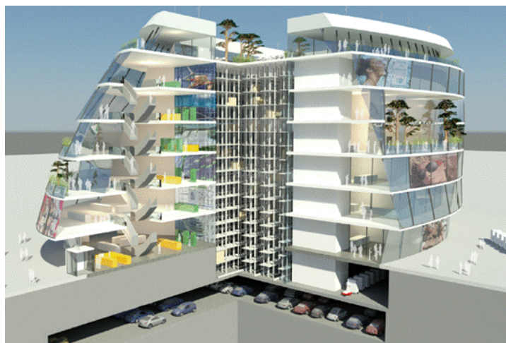
Rysunek 8. Koncepcja połączenia miejskiego terminala logistycznego z centrum handlowym, przekrój 3D
